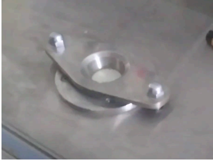
Şekil 49 Filtre Kağıdı Parçasının Test Cihazına koyuluşu
