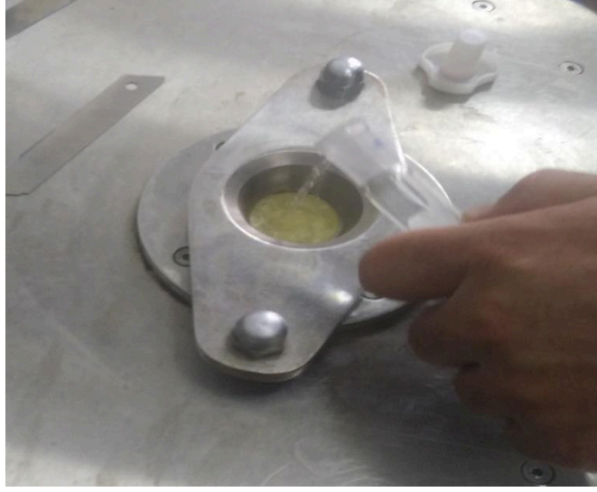
Şekil 57 Kađıdıın üstüne gözenek geçirgenliđi testi için alkol dökülmesi
