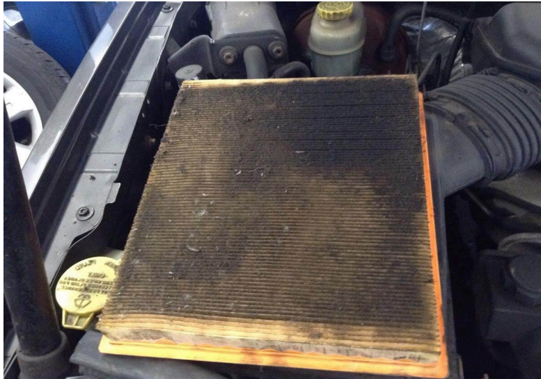
Şekil 4 Kullanılmış kirli, panel hava filtresi
