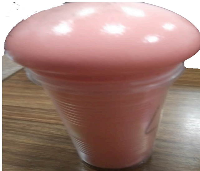
Şekil 8 Kabarmış, Somon renginde Poliüretan
