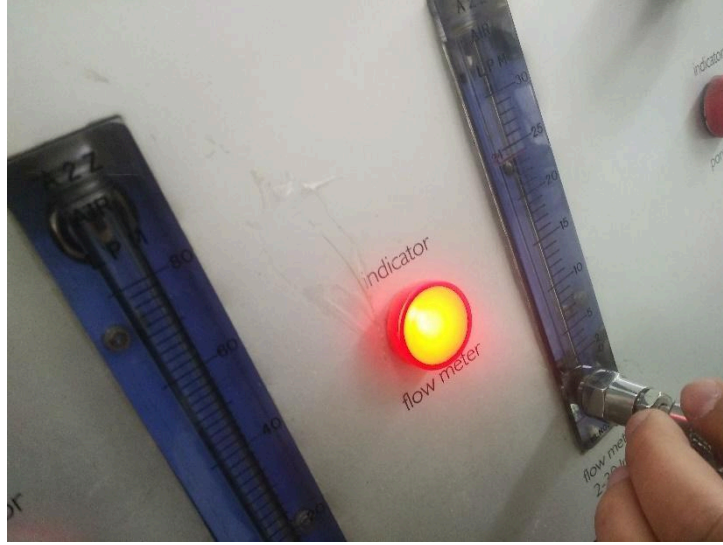
Şekil 55 Hava akış vanasının ayarlanması
